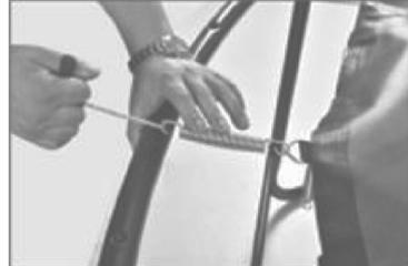
*Для крепления пружин используйте специализированный инструмент (G).*
