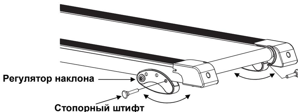
Беговую дорожку можно установить под тремя углами наклона, при помощи специального регулятора наклона. Возьмитесь одной рукой за задний край основной рамы тренажёра, затем приподнимите нижнюю часть дорожки, после чего свободной рукой вытащите стопорный штифт. Отрегулируйте положение тренажёра, а затем установите штифт в отверстия на основной раме и регуляторе, чтобы зафиксировать положение регулятора.
