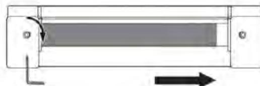
Если беговое полотно смещается влево, поверните левый регулировочный винт по часовой стрелке. Затем перейдите к правому винту и поверните его против часовой стрелки. Для регулировки воспользуйтесь шестигранным ключом.
