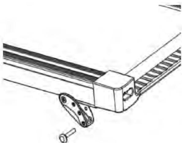
Угол наклона беговой дорожки можно изменить при помощи регулировочного штифта. В тренажёре предусмотрено три регулировочных отверстия, каждое из которых соответствует определённому углу наклона. Чтобы установить необходимый для Вас наклон тренажёра, вставьте штифт в отверстие, которое соответствует желаемому углу наклона. Убедитесь,
