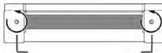
Возникновение пауз во время движения дорожки, а также проскальзывание бегового полотна говорит о том, что беговое полотно ослаблено. В этом случае регулировка бегового полотна производится следующим образом: поверните оба регулировочных винта на 3 оборота по часовой стрелке, после чего отрегулируйте полотно так же, как при смещении.
