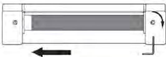
Если беговое полотно смещается вправо, поверните правый регулировочный винт по часовой стрелке. Затем перейдите к левому винту и поверните его против часовой стрелки. Для регулировки воспользуйтесь шестигранным ключом.
